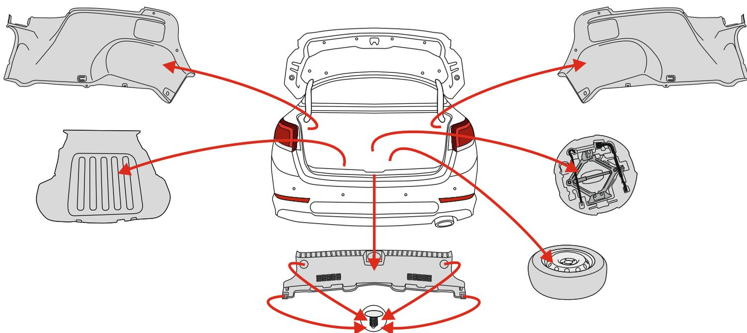
Элементы обшивки, которые рекомендуем демонтировать перед установкой комплекта проводки.
