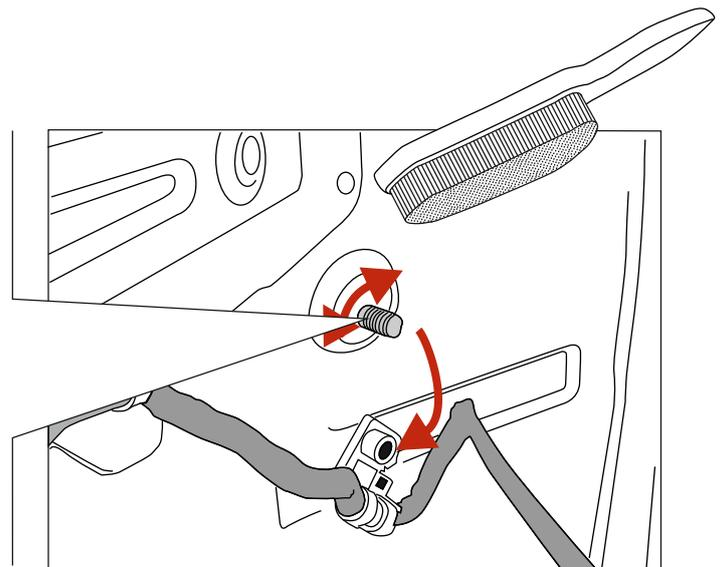
Снимите «клипсу» кабеля и произведите зачистку резьбы металлической щеткой.
