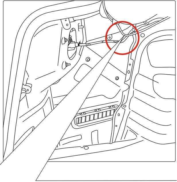
Ориентировочное место расположения жгута, в котором находится провод, отвечающий за сигнал противотуманного фонаря автомобиля
