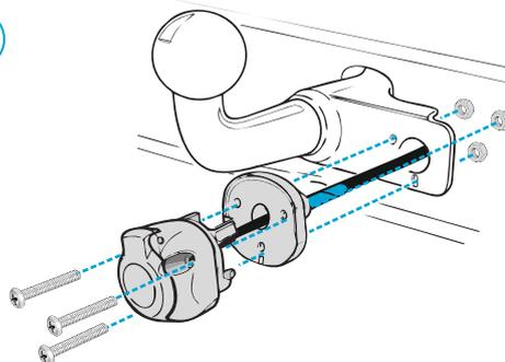
Закрепите розетку и пыльник на монтажной поверхности.
